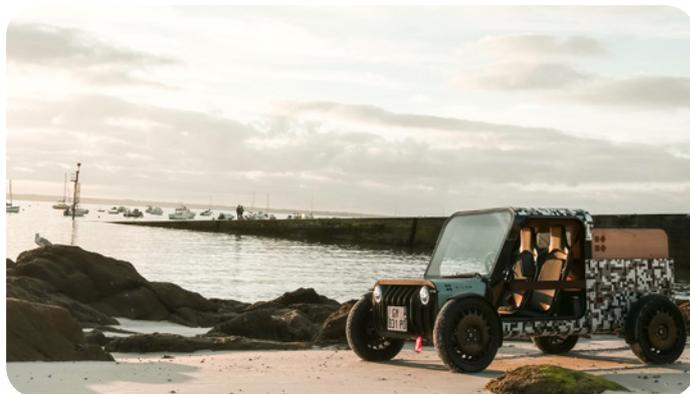
*"Lors de la commande, on définit les options avec le client et il choisit sa Bagnole. On peut rajouter portes, toit, mettre 1 ou 2 batteries, customiser sa benne qui supporte 150kg de chargement... Avec une autonomie de 70 à 135 km, un temps de recharge de 4 à 5h par batterie sur une prise classique de 220V, c'est un véhicule simple, léger",* précise Arthur Allamand, directeur commercial.
